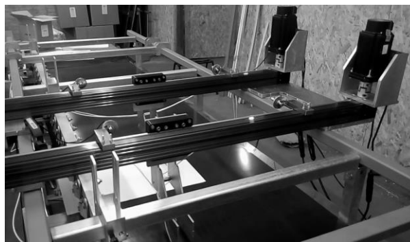
Рис. 5. Конвеєрний стіл автоматизованої системи в цеху підприємства
