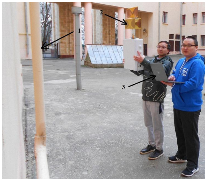
1 – Труба (неоднородность), 2 – антенный блок измерительного комплекса «TRF-1», 3 – компьютер для регистрации и обработки данных.
