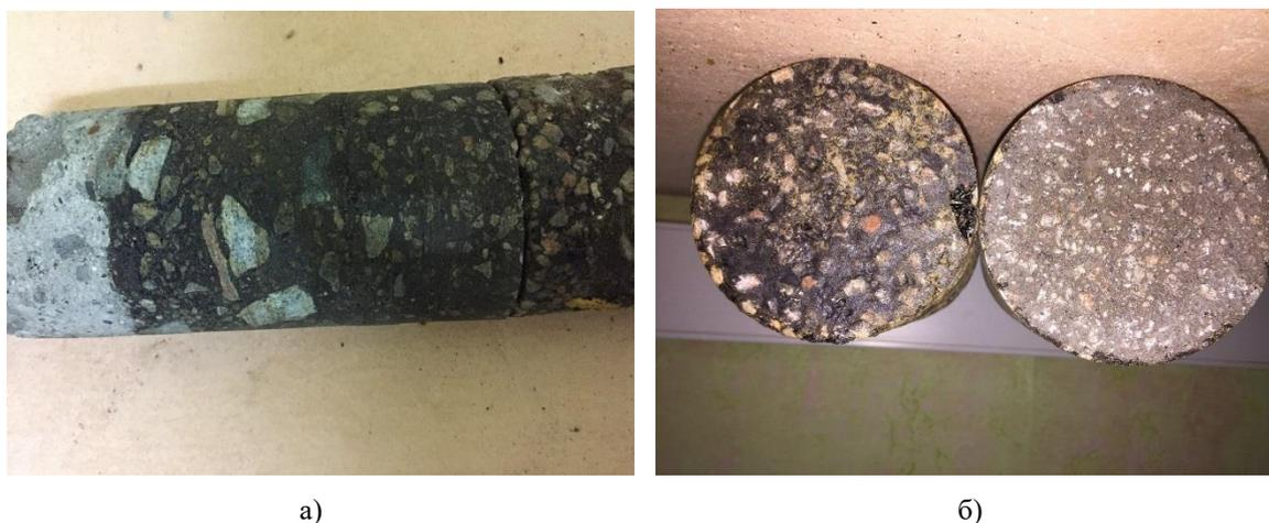
Рис.3. Керны с расслоением и плотным контактом. Общий вид (а) и вид разделенных поверхностей (б).
