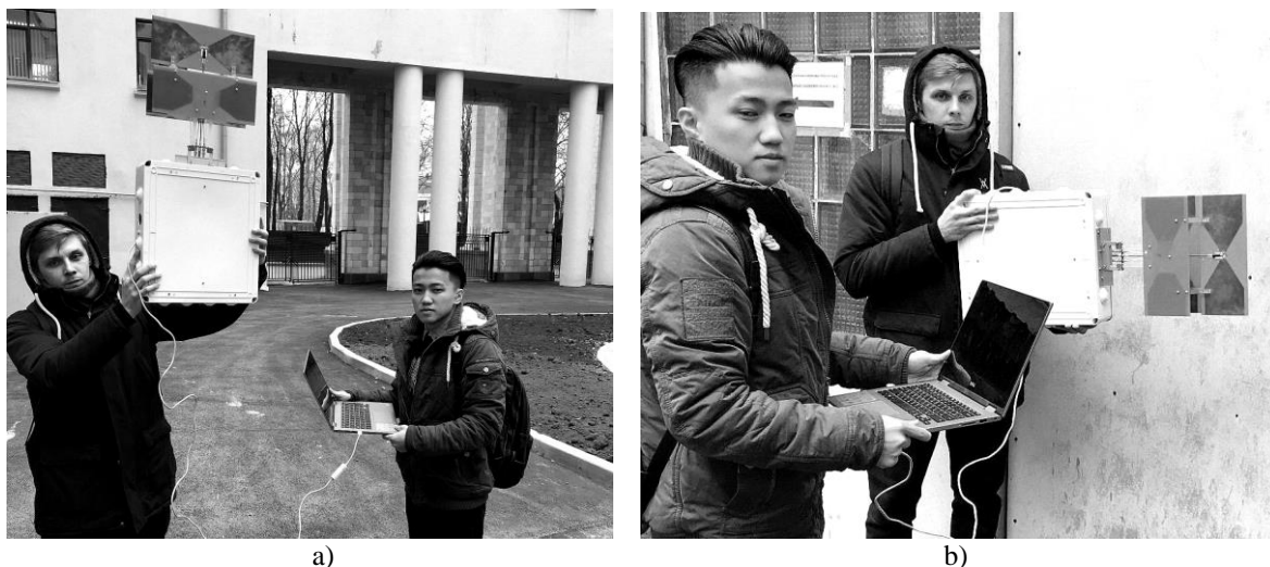
Рис. 1. Георадар «TRF-1» во время регистрации сигнала прямого прохождения (а) и записи сигнала, отраженного от листа металла (б).
