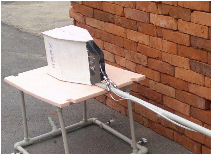
Рис. 2. Георадар «Одяг 1» во время экспериментов.
