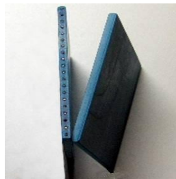
Рис. 1. Приклад зразка метаматеріалу для виготовлення підкладки прямокутної компактної НВЧ патч-антени (зліва) і зразка із матеріалу матриці тих же розмірів (справа)
