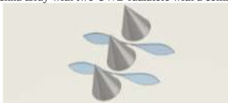
Рис. 8. Антенна решітка з двома НШС випромінювачами зі спільною Е площиною
