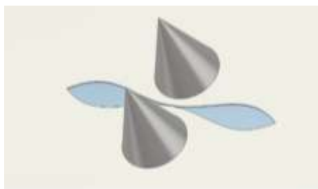
Рис. 2. Надширокопasmовий аналог випромiнювача Клевiна Fig. 2. Ultrawideband analogue of the Clavin radiator
