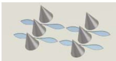
Рис. 9. Антенна решітка з чотирьох поєднаних НШС випромінювачів
