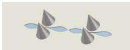
Рис. 7. Антенна решітка з двома НШС випромінювачами зі спільною Н площиною
