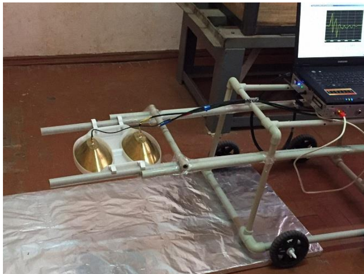
Рис. 4. Проведення калібрування для георадару Одяг-4.2.
