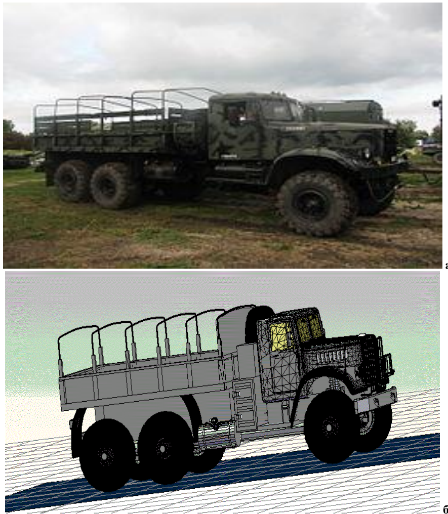
Рис. 1. Фотография КРАЗ 255 Б - (а) и расчетная модель грузовика, созданная в программе 3dМакс - (б)
