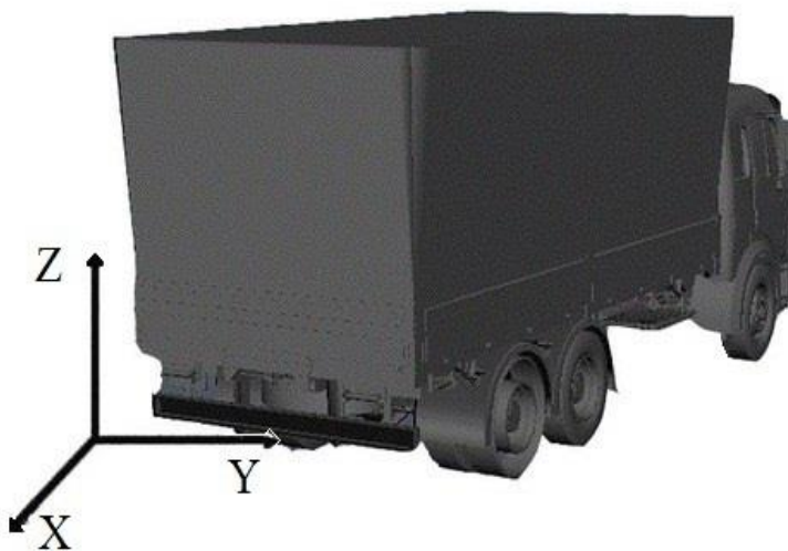
Рис. 6. Расчетная модель грузовика с наклонными стенками
