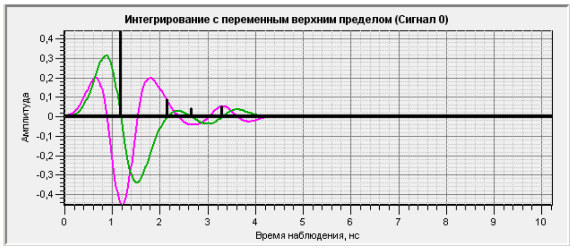
Рис. 4. Результат обработки с помощью интегрального преобразования [8] сигнала от трехслойной структуры (рис. 1) с низким электрическим контрастом верхних слоев и малой электрической толщиной.
