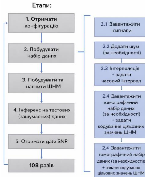
Рис. 1. Робочий процес дослідження простору параметрів, спрямований на визначення конфігурації з максимальною завадостійкістю
