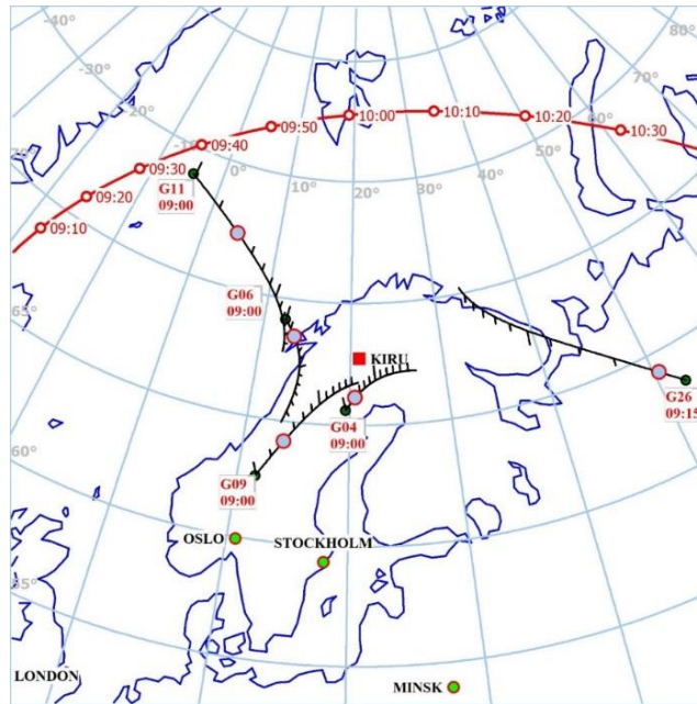
Рис. 18. Карта прольотів супутників відносно станції KIRU, м. Кируна в Швеції, в інтервалі часу з 08:00 до 11:00 UT. У 09:20 UT показані точки вимірювання у вигляді кругів
