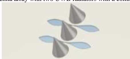
Рис. 8. Антенна решітка з двома НШС випромінювачами зі спільною Е площиною Fig. 8. Antenna array with two UWB radiators with a common E plane
