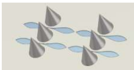
Рис. 9. Антенна решітка з чотирьох поєднаних НШС випромінювачів Fig. 9. An antenna array of four connected UWB radiators
