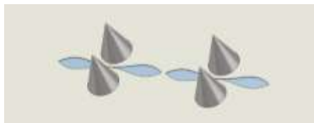
Рис. 7. Антенна решітка з двома НШС випромінювачами зі спільною Н площиною Fig. 7. Antenna array with two UWB radiators with a common H plane
