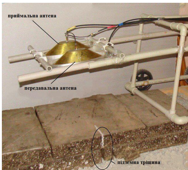
Рис. 4. Експериментальне встановлення. Fig. 4. Experimental installation.
