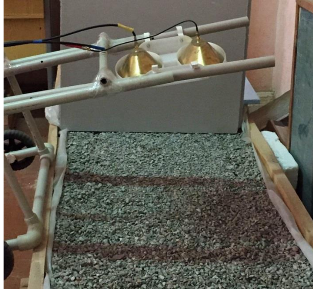
Рис. 5. Проведення лабораторних досліджень при нахиленому розташуванні антенного блоку георадару Одяг-4.2.
