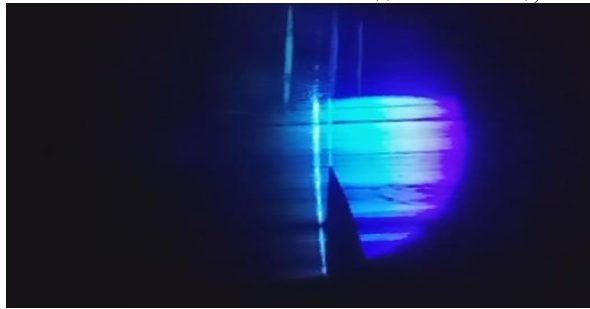
Рис.5. Приклад налаштування лазерів по дуговому розряду ліній цинку
