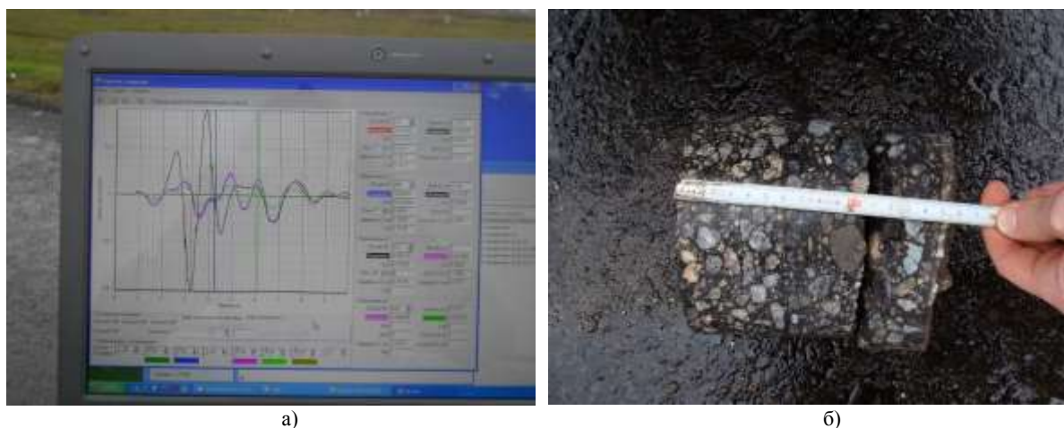
Рис. 3. Оценка и верификация глубины залегания границ трещины: а) окно монитора; б) фактическое значение
