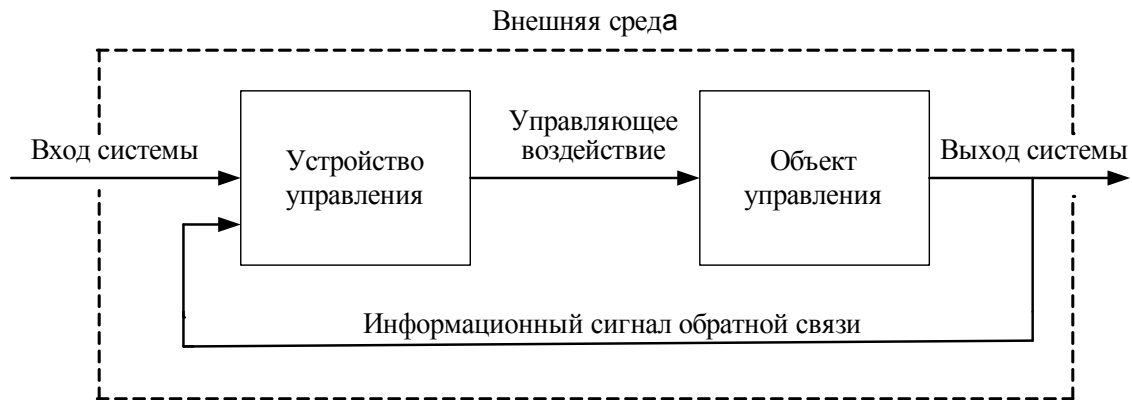
Рис. 1. Общая структура и принцип построения управляющей системы
