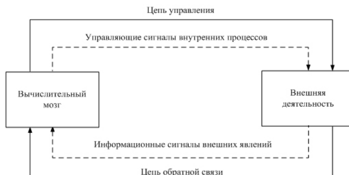
Рис. 5. Система управления восприятия и обработки информации об окружении
