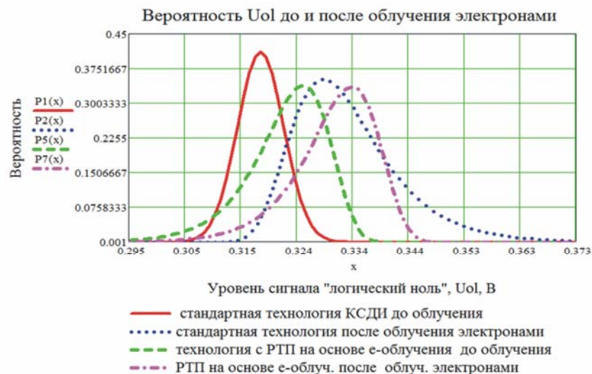
Рис. 4. Вероятность численного значения U_{OL} для ИС, изготовленных с применением РТП (технологическое облучение электронами) и по стандартной технологии «кремний с диэлектрической изоляцией» до и после облучения электронами с энергией 5 МэВ ( \Phi_e \cong 1 \cdot 10^{13} \text{ см}^{-2} )
