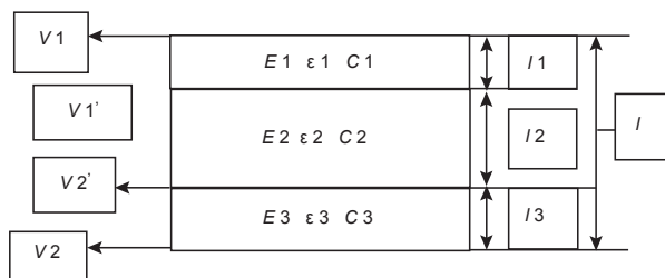
Рис. 1. Расположение диэлектриков в многослойном конденсаторе
