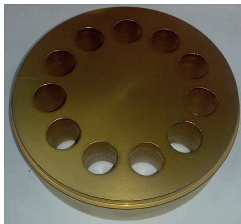
Рис. 10. Фотография матрицы с многослойным покрытием с предварительно азотированным слоем
