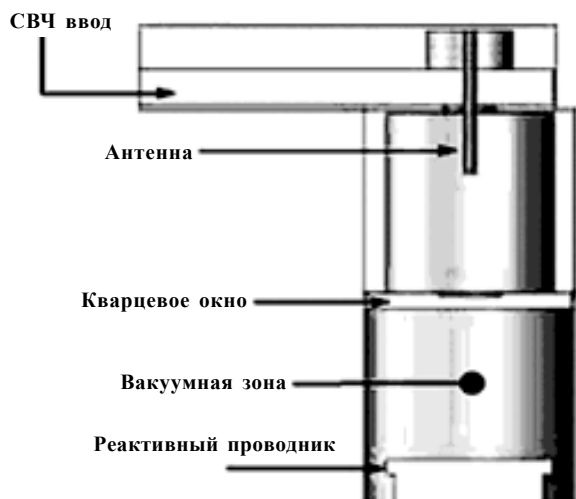
Рис. 3. Сечение MWP CVD устройства, использованного в работе [6], соответствующего установке AX-5250, производимой Seki Technotron Corp.
