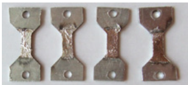
Рис. 1. Образцы алюминиевого сплава Амг6, обработанного СРЭП
