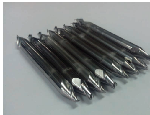
Рис. 9. Конусная фреза с многослойным вакуумно-дуговым покрытием MoN/CrN
