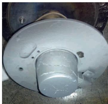
Рис. 1. Фотография паяного Сг катода с трещинами
