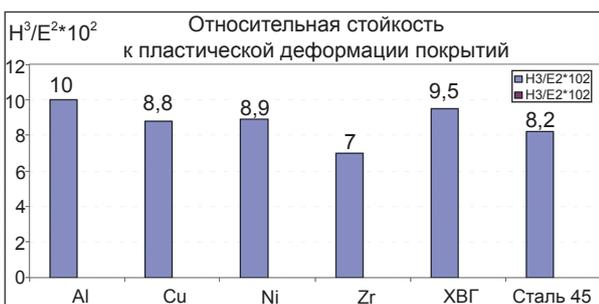
Рис. 5. Гистограммы механических свойств карбидохромовых покрытий и материалов подложек
