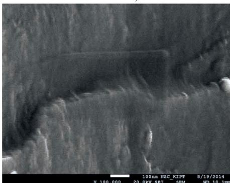
Покрывтие, полученное при  $T_{oc.} = 495-465^{\circ}C$  (обр. № 429; схема 2)
