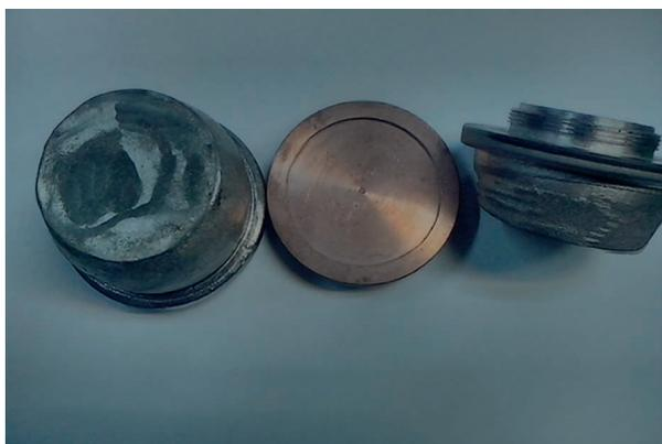
Рис. 3. Многокомпонентные катоды, паянные медно-серебряным припоем
