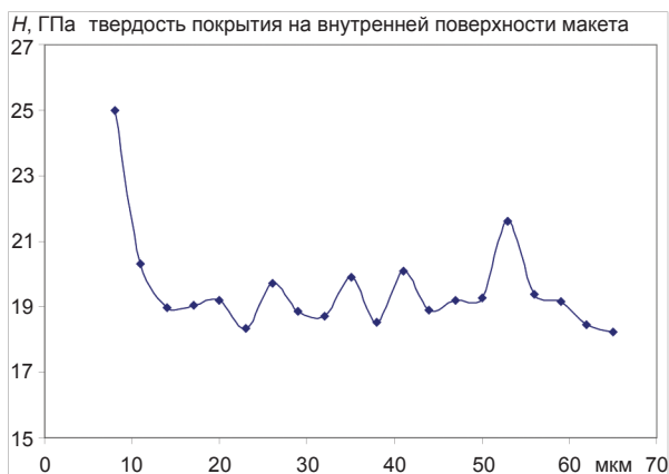
Рис. 5. Нанотвердость на вогнутой поверхности
