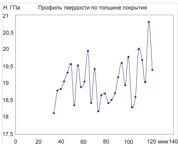
Рис. 6. Нанотвердость на выпуклой поверхности косого шлифа под углом 55° к нормали роста покрытия
