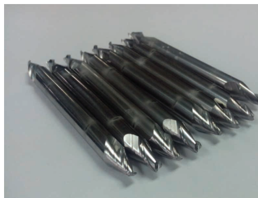
Рис. 9. Конусная фреза с многослойным вакуумно-дуговым покрытием MoN/CrN
