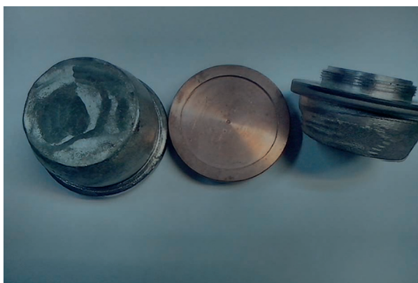
Рис. 3. Многокомпонентные катоды, паянные медно-серебряным припоем
