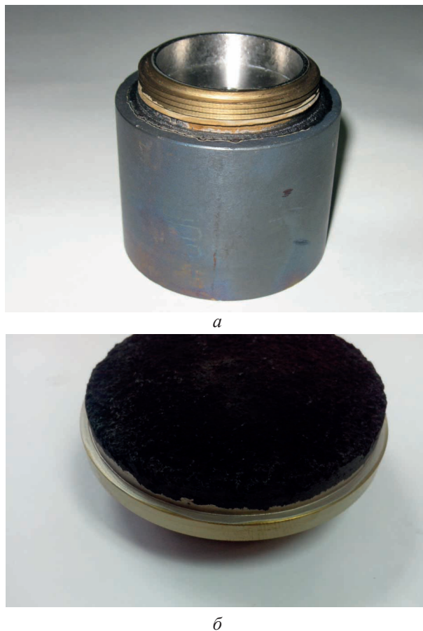
Рис. 9. Фотография молибденового (а) и графитового (б) катода, спаянного с титановой резьбовой частью медным припоем
