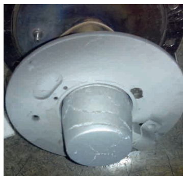
Рис. 1. Фотография паяного Сг катода с трещинами
