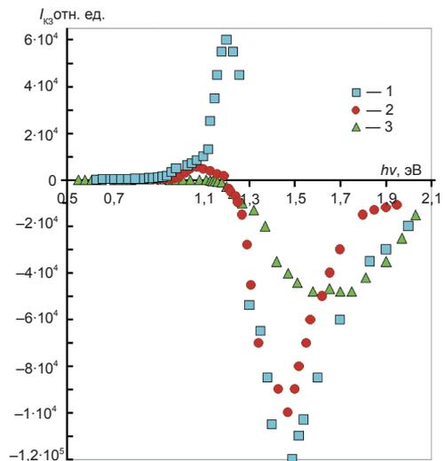
Рис. 1. Спектральные зависимости  $I_{кз}$  для структуры CdTe-SiO<sub>2</sub>-Si от величины потенциала коронного разряда:  $\phi_{кр} = 80$  В (кривая 1), 50 В (2), 0 В (3)
