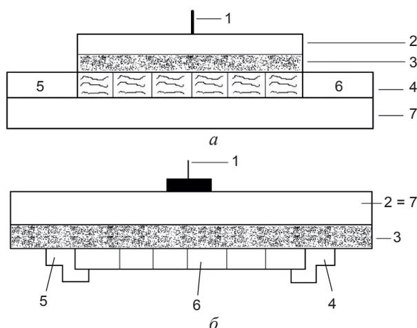
Рис. 2. Поликристаллическая структура на основе кремния (а) [2] и CdTe-пленок (б); а: 1, 2 — управляющий электрод, 3 — SiO<sub>2</sub>, 4 — Si, 5 — сток, 6 — исток, 7 — изолятор; б: 1 — управляющий электрод, 2 — Si, 3 — SiO<sub>2</sub>, 4 — исток, 5 — сток, 6 — CdTe
