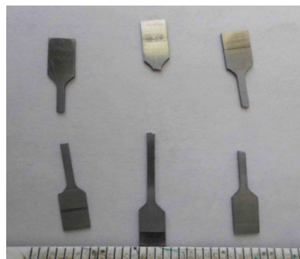
Рис. 4. Общий вид образцов после испытания на разрывной машине
