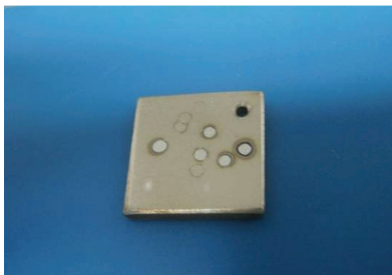
Рис. 5. Вид образца после проведения SIMS и GDMS исследований
