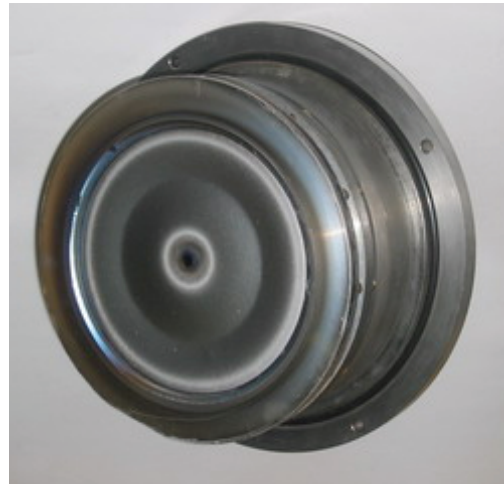
Рис. 2. Схема та фото магнетрона на постійних магнітах
