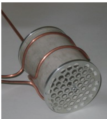
Рис. 4. Схема та фото джерела ВЧІ плазми
