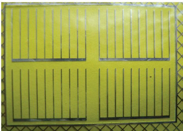
Рис. 3. Зовнішній вигляд дослідного зразка тонкоплівкового ємнісного перетворювача для акустичного контролю металевих виробів
