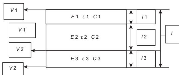
Рис. 1. Расположение диэлектриков в многослойном конденсаторе
