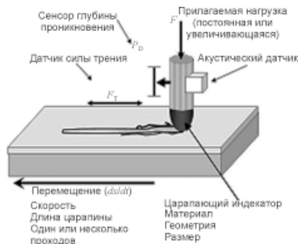
Рис. 6. Схема метода склерометрии.
