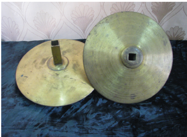
Рис. 3. Загальний вигляд латунних дисків вібратора радіопередавача для бездротового телеграфування.
