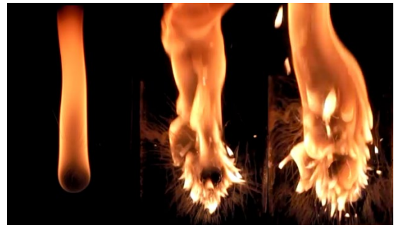
Рис. 5. «Мікробибухи» при горінні емульсії дизельне паливо-вода (50%/50%) на стаціонарній сфері.
