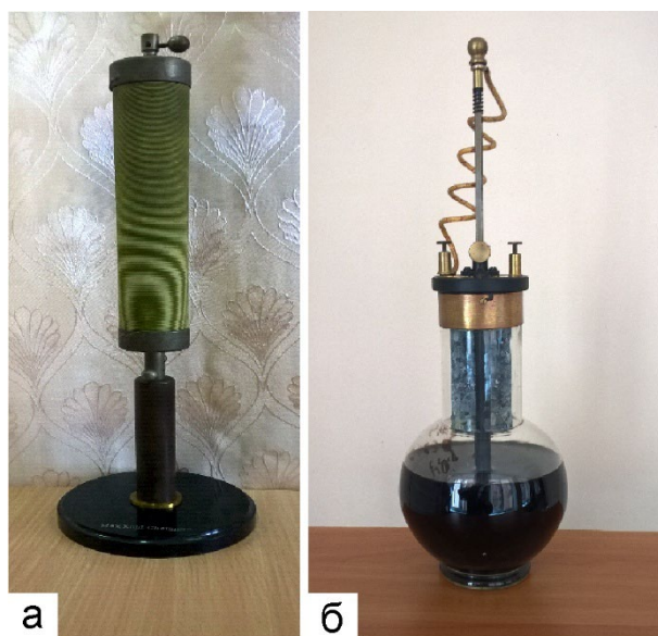
Рис. 15. «Стовп» Замбоні (а) і гальванічний елемент Грене (б) із колекції приладів фізичного кабінету Харківського університету.
