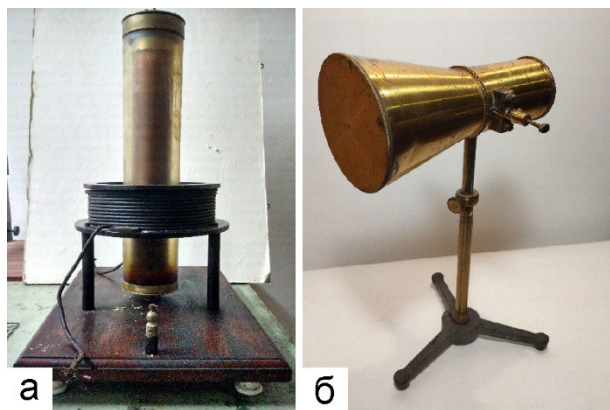
Рис. 26. Трансформатор Тесла (а) виробництва фірми «Max Kohl A. G.» та прилад «Термостовп Мелоні» (б) із колекції приладів кафедри фізики НТУ «ХПІ».
