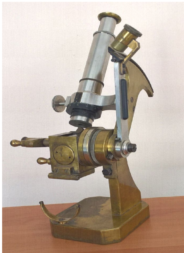
Рис. 7. Загальний вигляд рефрактометра Ернста Аббе виробництва фірми Карла Цайса з колекції приладів фізичного кабінету Харківського університету.
