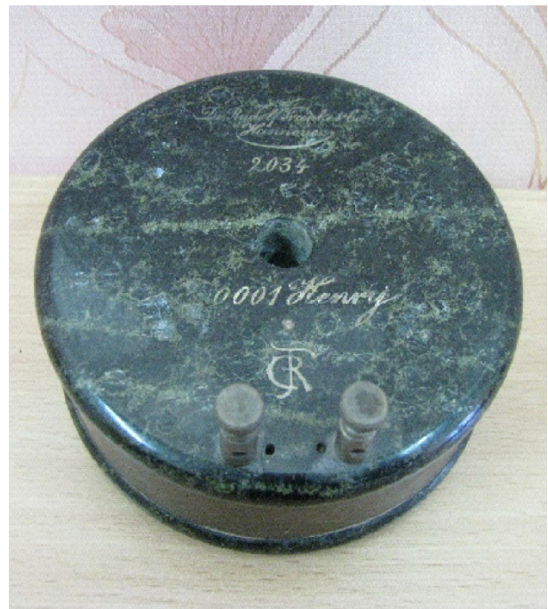
Рис. 13. Еталонна котушка індуктивності, виготовлена фірмою «Dr. Rudolf Franke & Co» з колекції приладів фізичного кабінету Харківського університету.
