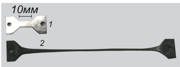
Рис.10. Зразки сплаву 1460: 1 - вихідний, недеформований. 2 - надпластично продеформований до зруйнування на 1000% при T = 793\text{K} і \sigma = 3,5 \text{ МПа} .
