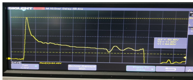
Рис. 5. Вольт-секундна характеристика процесу перемикавання у плівці телуриду кадмію.
