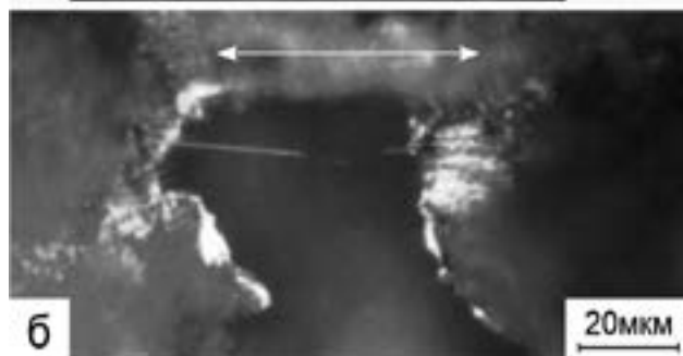
Рис.4. Види волокнистих структур у робочій частині зразків сплаву 01420Т, продеформованих до зруйнування в оптимальних умовах надпластичності. Стрілками вказано напрямок розтягування зразків. Світлова мікроскопія.
