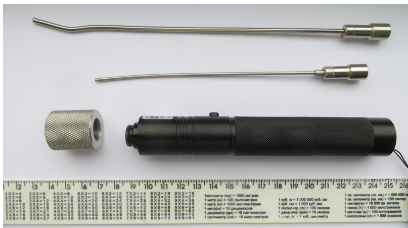
Рис. 2. Устройство лазерное мобильное для облучения глубоких раневых каналов и полостей
