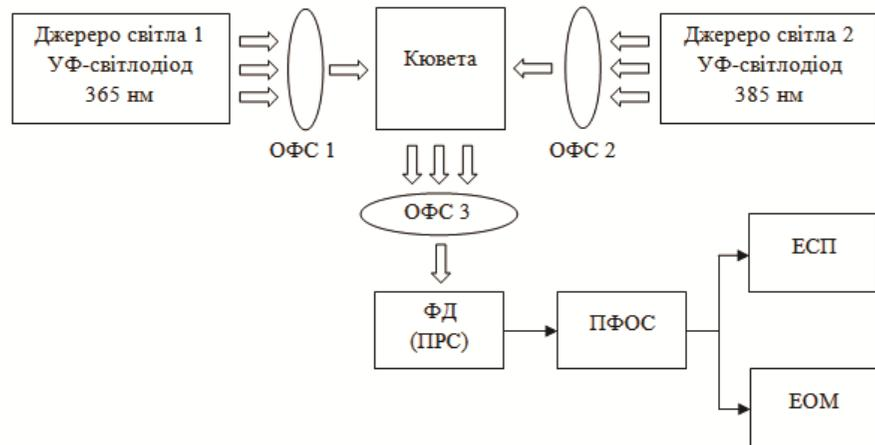
Рис. 1. Структурна схема макету вимірювального засобу «Люмінес»
