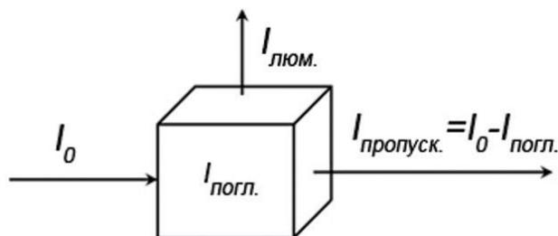
Рис. 2. Схема збудження люмінесценції в досліджуваних зразках
