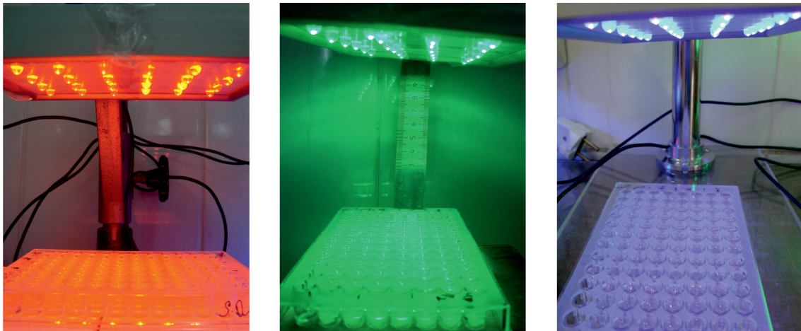
Рис. 2. Фотонна матриця Коробова «Барва-Флекс» з світлодіодами помаранчевого, зеленого та фіолетового спектрів
