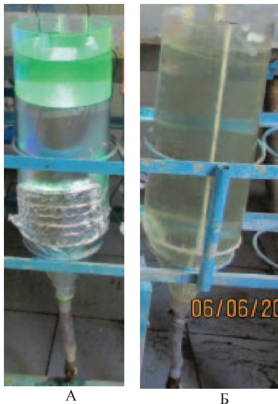
Рис. 1. Аппараты Вейса с облучением зеленым светом (А) и без дополнительного облучения (Б)
