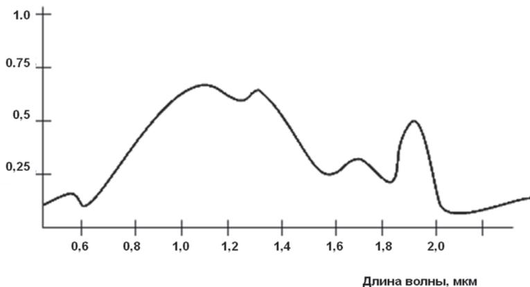
Рис. 1. Зависимость коэффициента пропускания биоткани от длины волны
