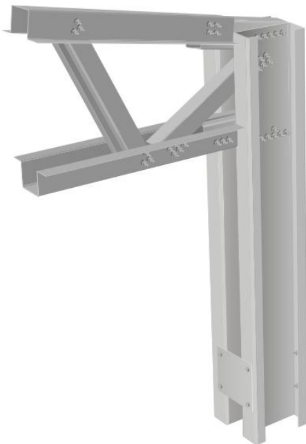
Рис. 2. Схема болтових з'єднань швидкокомбованої будівлі LLENTAB
