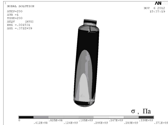
Рис.4. Эквивалентные напряжения по Мизесу
