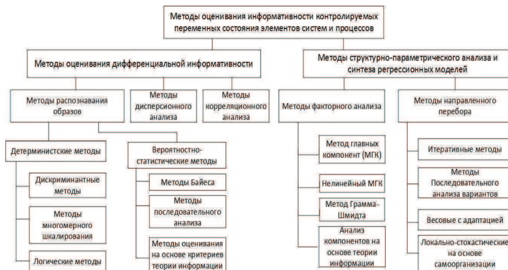
Рис.1 Классификация методов оценивания информативности контролируемых переменных состояния элементов систем и процессов
