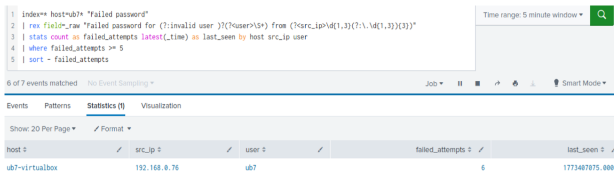
Рис. 2 Результат агрегації подій невдалих SSH-входів у Splunk
