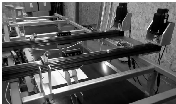
Рис. 5. Конвеєрний стіл автоматизованої системи в цеху підприємства
